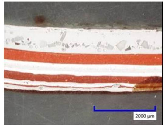
図1 厚膜化した塗膜の断面
