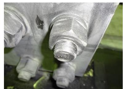
図-4 加熱後の塗膜剥離状況
