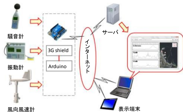
図-3 設置構成の例 (風向・風速・騒音・振動)
