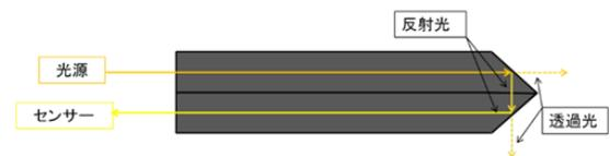
図2.9 光ファイバーセンサー原理（断面図）
