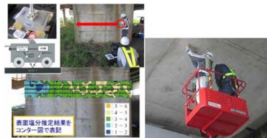
写真 1 近赤外線法による表面塩分分布調査
