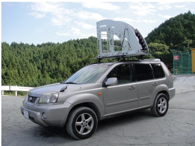
写真-1 走行型計測装置【高精度撮影型】
