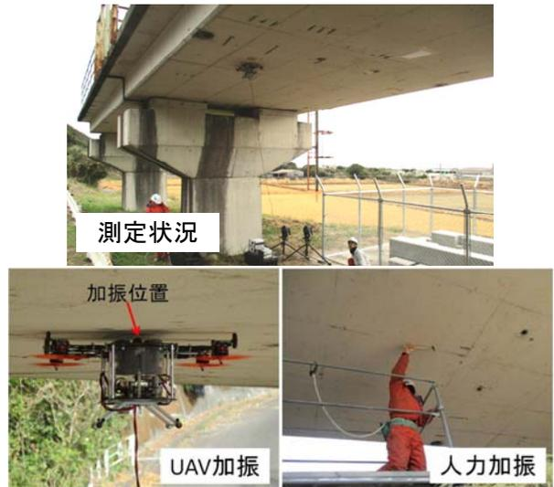
図5 測定状況および加振状況
