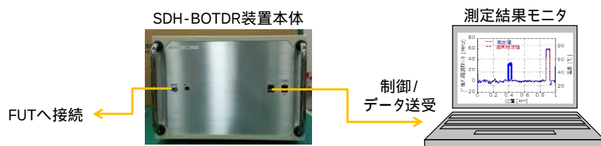
図 1 SDH-BOTDR の装置外観
