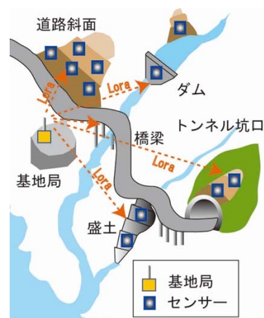
図-1 斜面モニタリングシステム概念図
