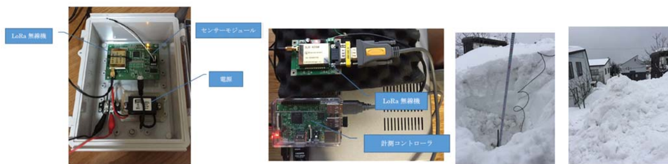
図-2 LoRa 実験機材 (a)子機 (b)親機
