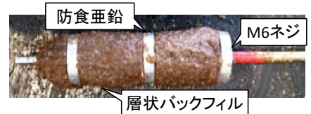
写真-1 設置した防食亜鉛ユニット
