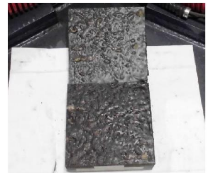
写真-1 試験体の破壊面 (上: レベリング層側, 下: 床版側)
