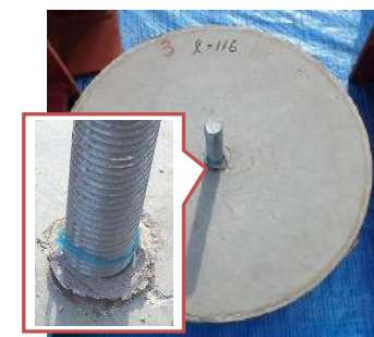
図-7 荷重急低下後状況 (試験体3)
