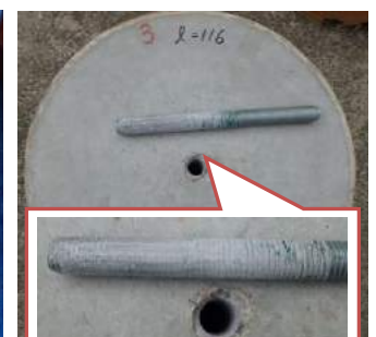
図-8 再引抜き後状況 (試験体3)
