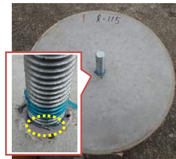
図-5 荷重急低下後状況 (試験体1)
