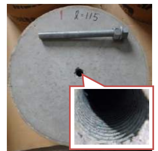
図-6 アンカー抜取り後状況 (試験体1)
