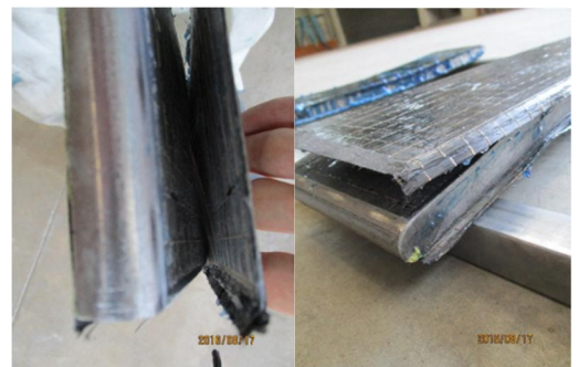
図 4 CFRP 剥離状況(L=400:CASE4)
