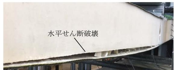
図5 曲げ実験供試体 水平せん断破壊状況
