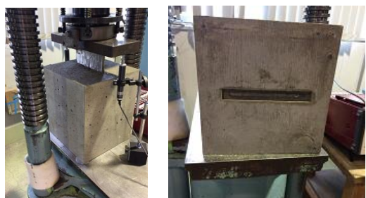
写真-1 押し抜きせん断実験概要図と供試体の下部
