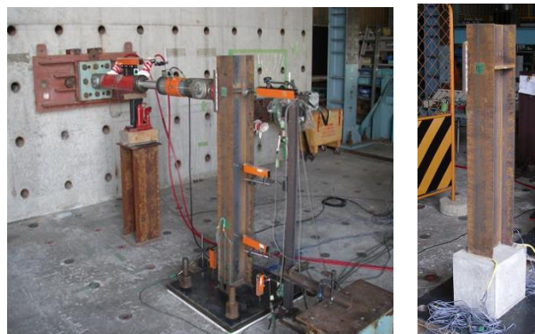
写真-2 供試体補強前と供試体補強後
