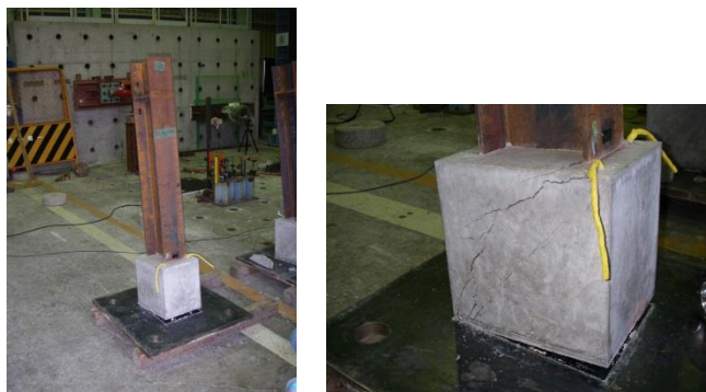
写真-3 供試体補強後の水平載荷試験後の状態
