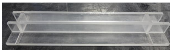
図-3 アクリル製型枠
