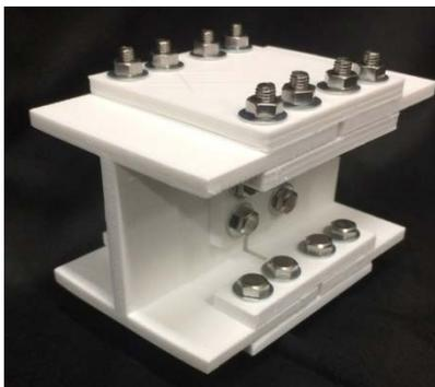
写真 6 高力ボルト継手
