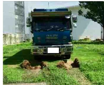
図-4. 芝生保護材未施工箇所陥没
