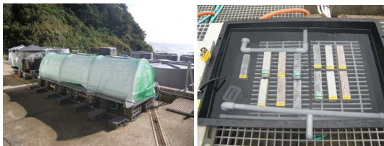
写真 水槽 (左) と試験体 (右) の設置
