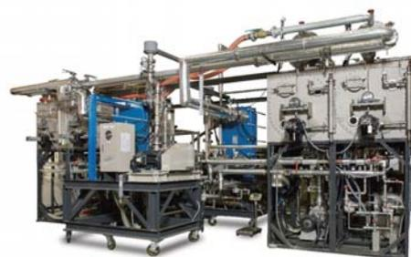
図-3 熱回収型 VCC 実証機の外観
