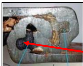
写真2 遮水専用鋼矢板 板継手部 (爪部)
