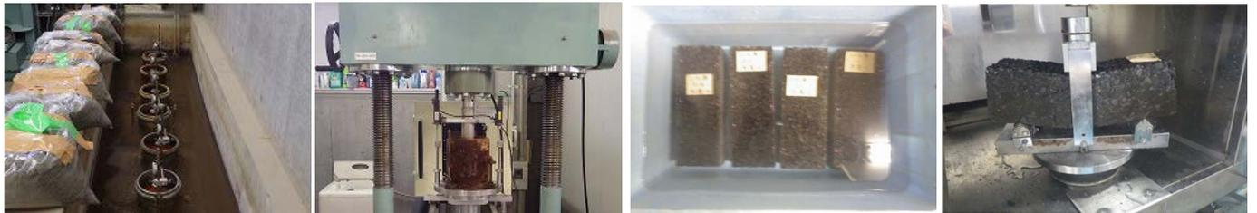
写真-1 CBR 供試体水浸養生 写真-2 試験状況 写真-3 曲げ供試体水浸養生 写真-4 試験状況
