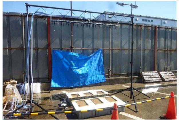
図-3 人工降雨装置による試験状況
