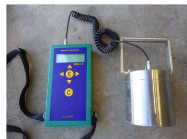
図-2 超小型動的平板載荷試験装置
