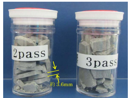
図-2 大型ロールプレスを通させた板状ベントナイトペレット
