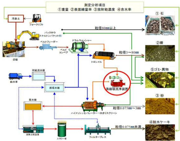
図 1 分級洗浄処理フロー図
