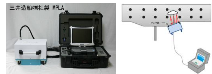
図-3 ハンチ形状に合わせて製作した電磁波レーダー装置 舗装面
