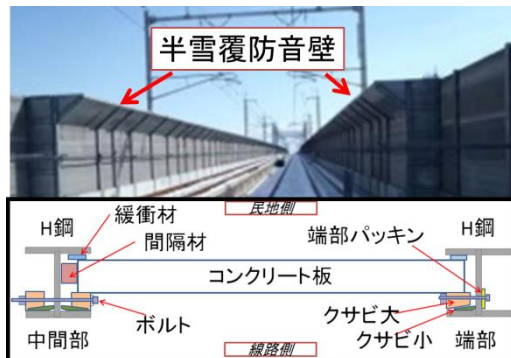
図-1 上) 半雪覆防音壁全景,
