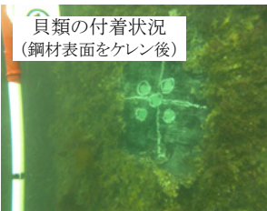
図-2 岸壁構造・測定水深 写真-1 鋼管矢板の外観
