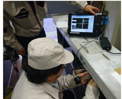
図-2 実き裂導入試験体の探傷状況
