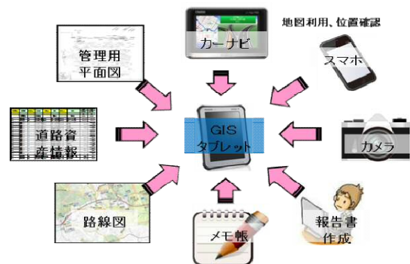
図-2 重畳機能電子野帳の構成
