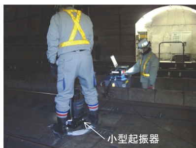
写真1 起振器試験実施状況
