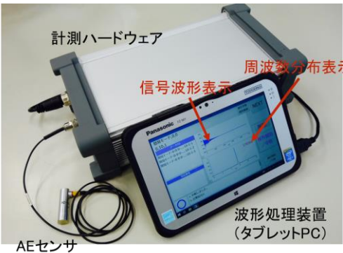
図 1 現場検査装置の構成及び外観
