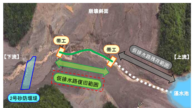
図-2 仮排水路復旧工事の概要図
