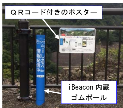
写真-2 iBeacon 内蔵ゴムポール (屋外：やんば見放台)
