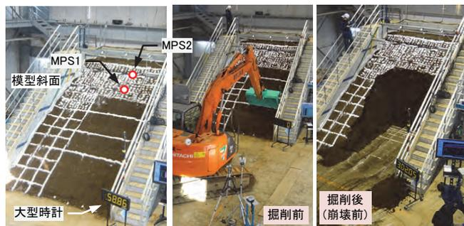
図-4 模型斜面を部分掘削する様子
