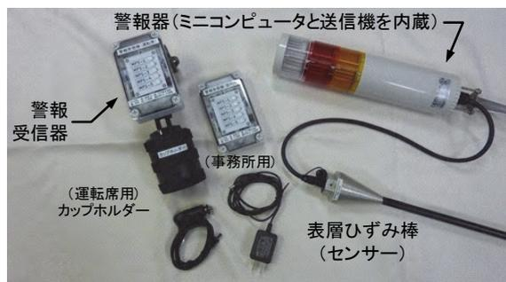
図-3 土砂崩壊の簡易危険検出システムの構成
