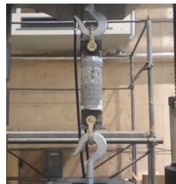
写真-2 直接引張試験の状況
