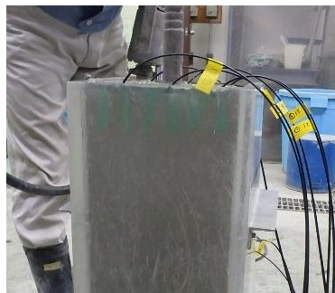
写真-3 締固め時の状況
