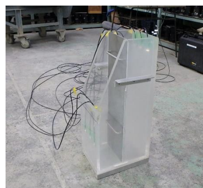
写真-1 実験用型枠
