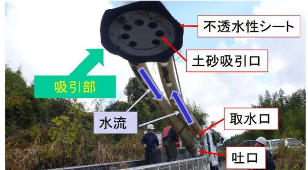
写真-1 管径 300mm 潜行吸引式排砂管
