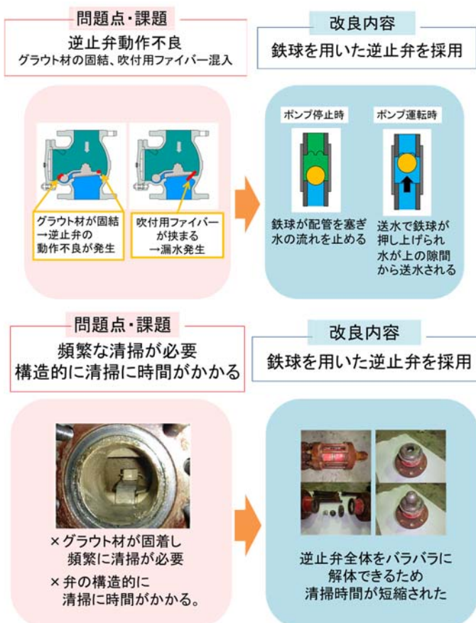
図5 鉄球を用いた逆止弁
