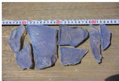
写真-10 排出された空間保持材
