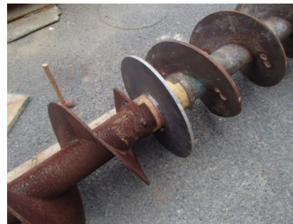
写真-1 シャッター板模擬鉄板
