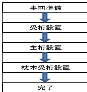
図-4 工事桁分割架設フロー
