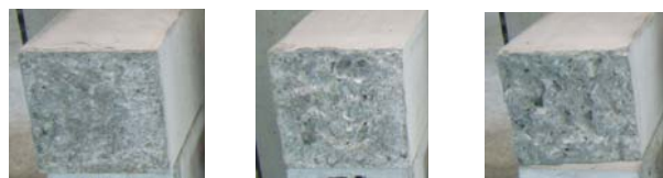
写真-1 ケース2 割裂面
