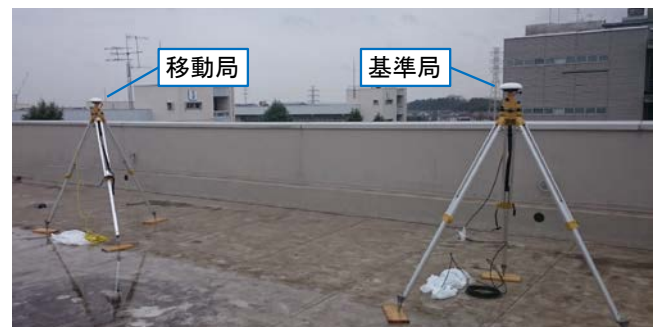
図-1 基準局と移動局の観測機器設置状況
