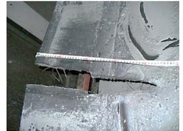
写真-1 コンベアゴム損傷
