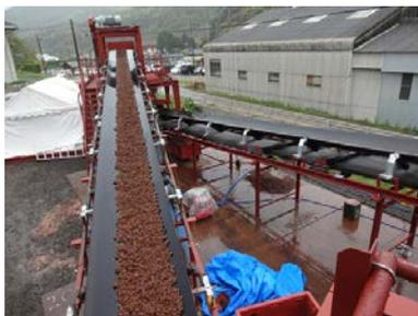
写真-2 実験用連続ベルコン
