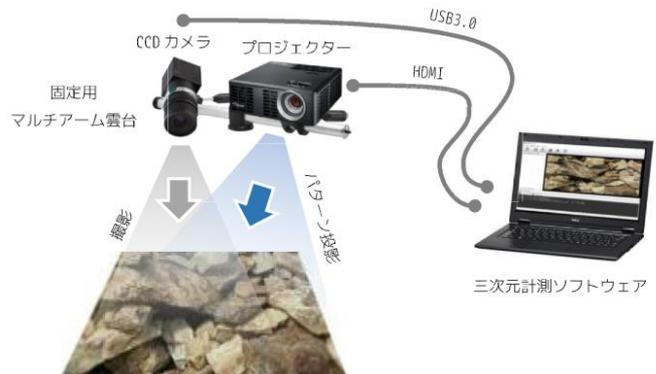
図-1 三次元画像計測システムの構成
