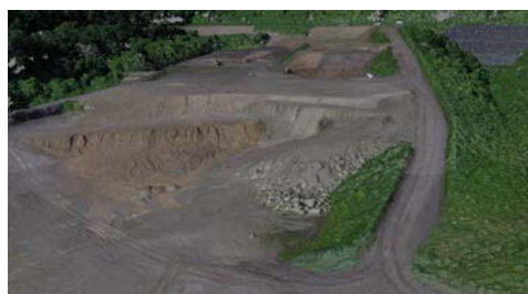
図-3 3D モデリングで得られた点群データの例
