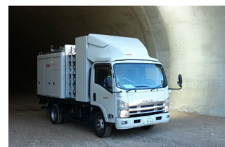
(b) 走行型高速 3D トンネル点検システム車
