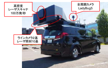
図-1 起工測量に使用した MMS
